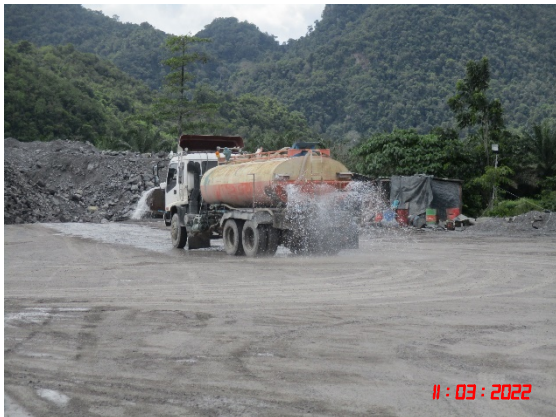
รูปที่ 2-14 ระบบป้องกันผลกระทบสิ่งแวดล้อมบริเวณโรงโม่บด และย่อยหิน
